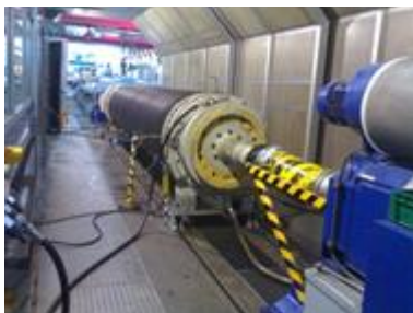
Fig. 1 Suction press roll
