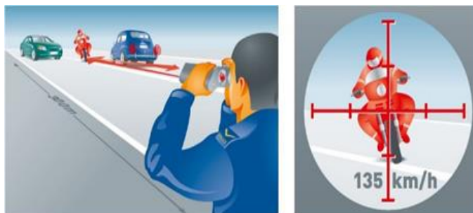
Слика бр. 4. Селективно мануелно мерење брзине ласером (METAS 2013)
