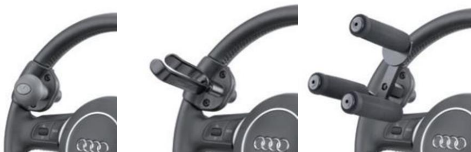
Слика бр. 4. Ручна помагала причвршћена за волан
