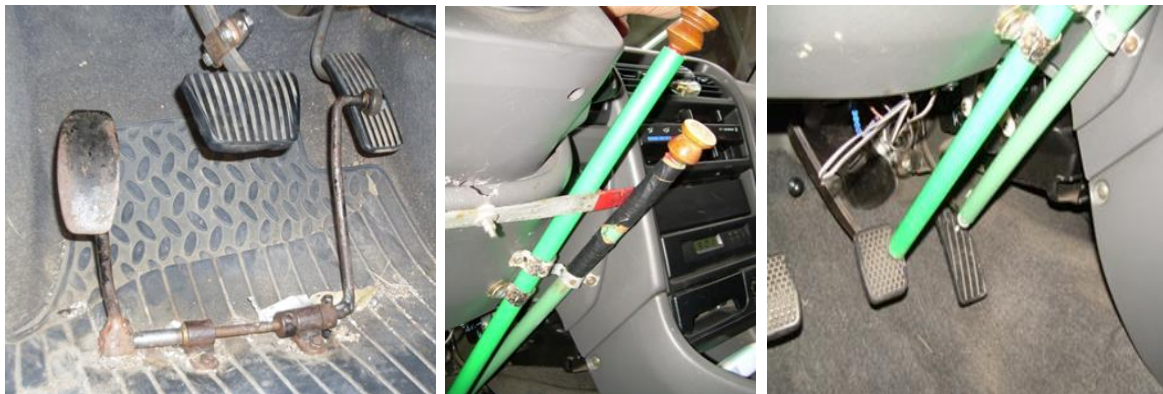
Слика бр. 13. Адаптација возила према потребама возача са посебним потребама
