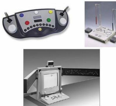
Slika br. 2. Vienna Test sistem za ispitivanje psihomotornih sposobnosti vozača(Schuhfried, 2014).
