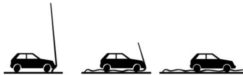
Слика 12. Primjer ponašanja stuba prilikom naleta vozila
