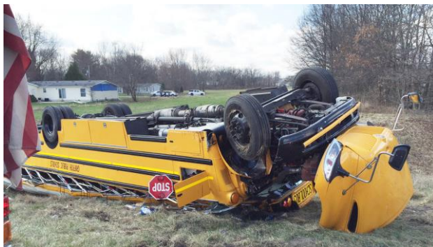
Slika 9. Potpuno narušavanje konstrukcije autobusa kod nezgode prevrtanja
